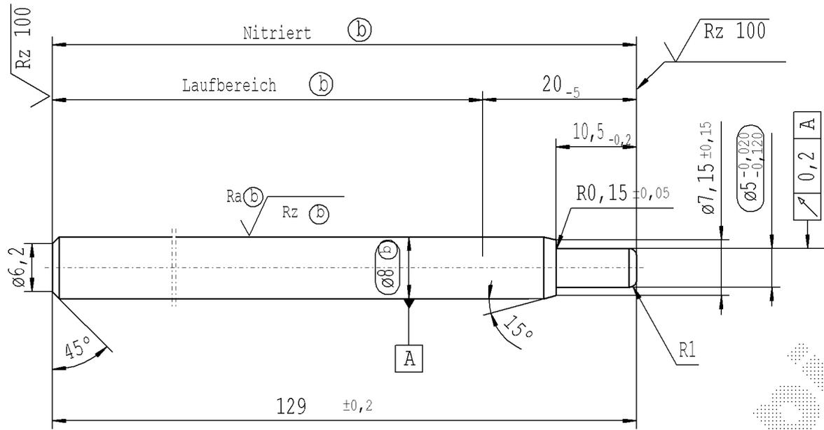
Fremdfertigung \* Material 1.1193 S45C JISG 4051
