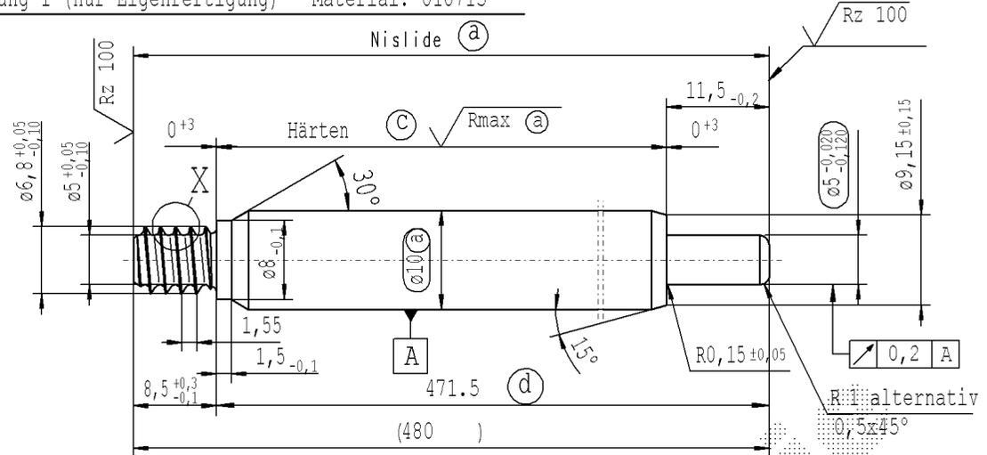
(c) vor dem Schleifen: Einhärtetiefe und Härteprüfung nach STAB-Spec. 10258370
