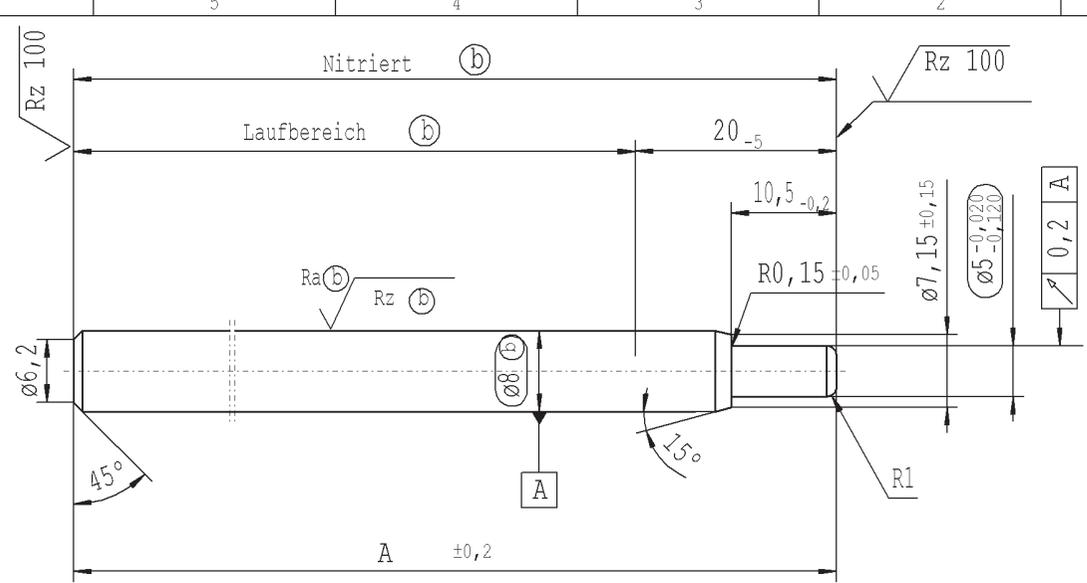
Fremdfertigung \* Material 1.1193 S45C JISG 4051
